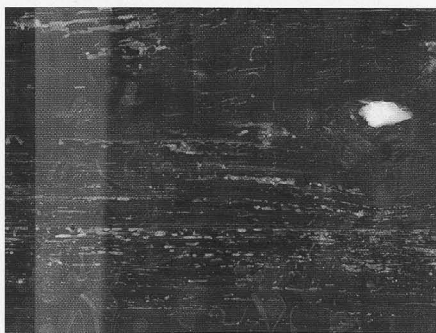
1. Radiografia, sono evidenti le gallerie scavate dai tarli e riempite di stucco.
